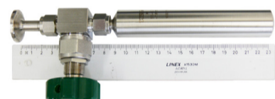
Abb. 3: Gasmaus zur Beprobung von Spaltgasen aus dem Brennstoffplenum
