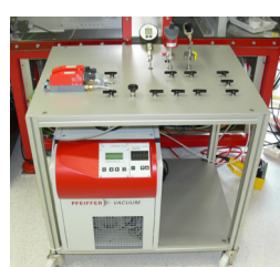
Abb. 6b: Prototyp der Gasmisch- und Verdünnungsapparatur
